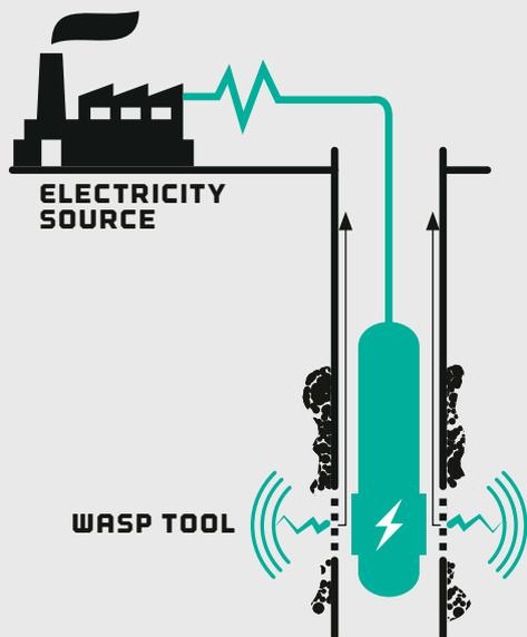
**EVERY PULSE USES THE SAME ELECTRICAL ENERGY AS IS FOUND IN A TABLESPOON OF ORANGE JUICE, YET WASP CREATES A 250-MEGAWATT PULSE AT THE BOTTOM OF THE WELL.**
